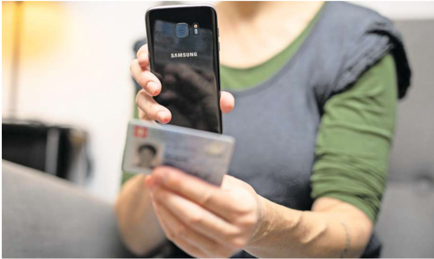
So funktioniert eine staatliche E-ID-Lösung mit Identitätskarte: Man hält die ID ans Handy, und eine App liest die Daten aus. Bild: Britta Gut
