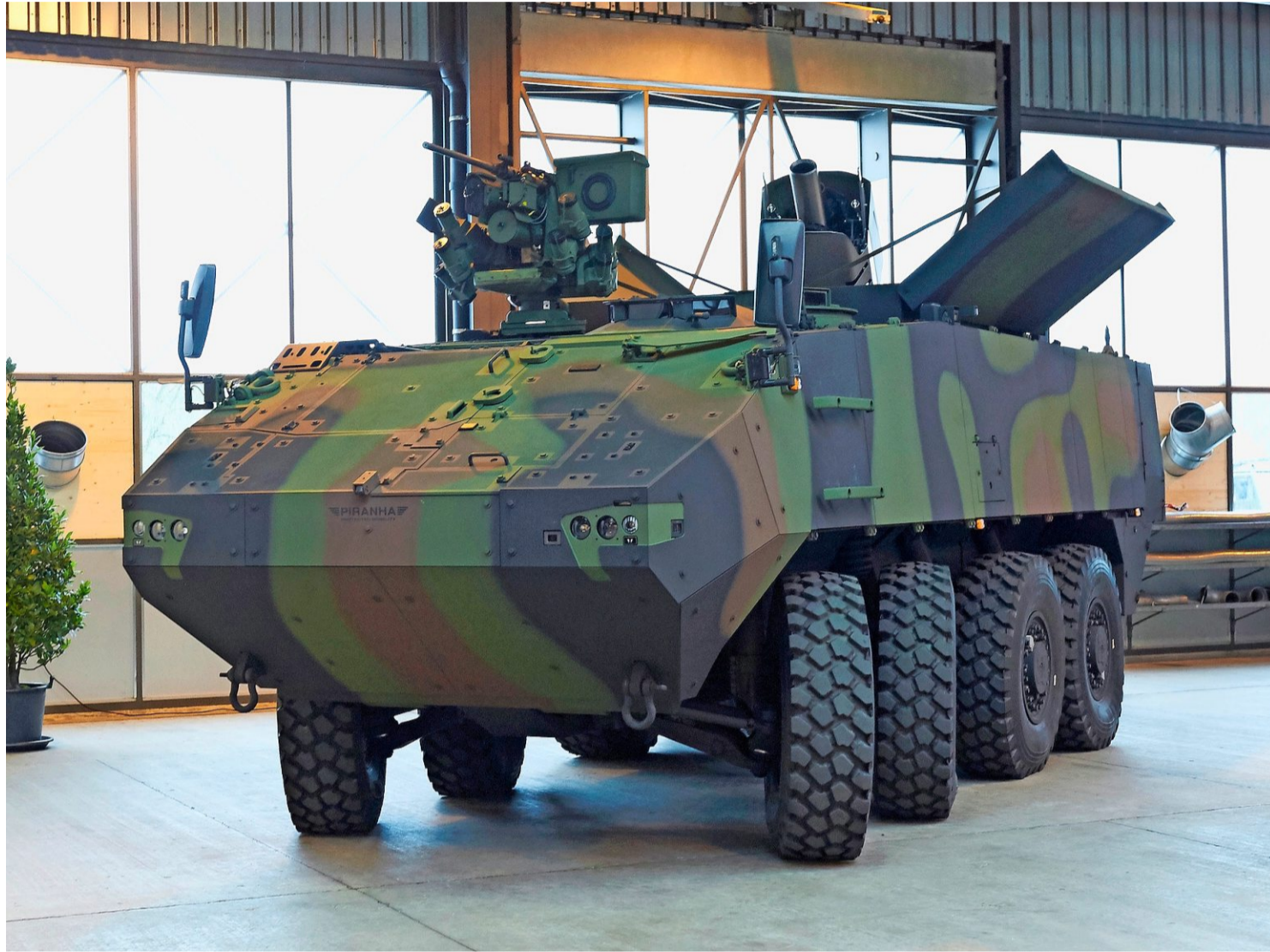
Als das Rüstungsprogramm 2016 vorgestellt wurde, war der Piranha 8x8 das Trägerfahrzeug des Mörsers 16. Foto: Dominique Schütz (VBS)
